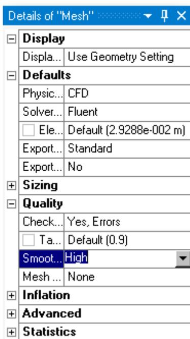
次に、OutlineでMeshが選択されている状態のまま、モデルを選択します。さらに右クリックし、[Insert]-[Sizing]を選択します。
